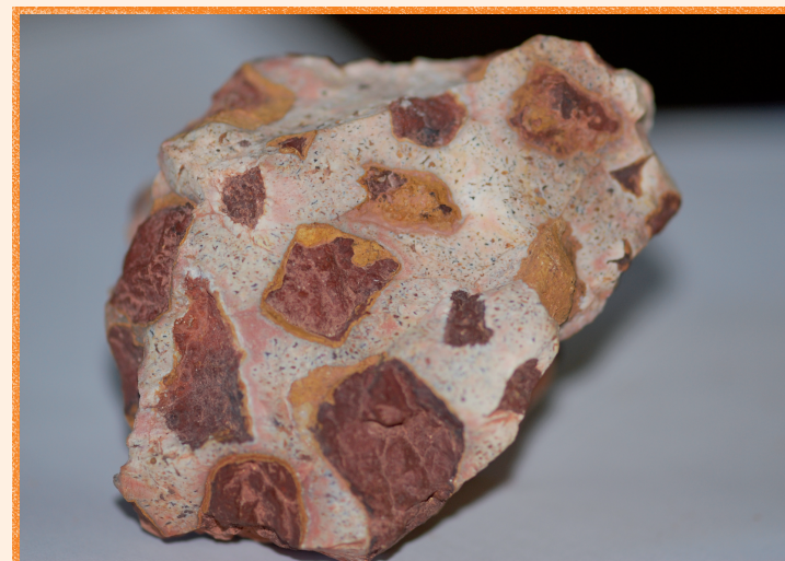
Bauxites à texture pisolitique (les pisolites jaunâtres à rougeâtres, riches en fer, sont contenus dans une matrice claire riche en oxydes et hydroxydes d'aluminium).
