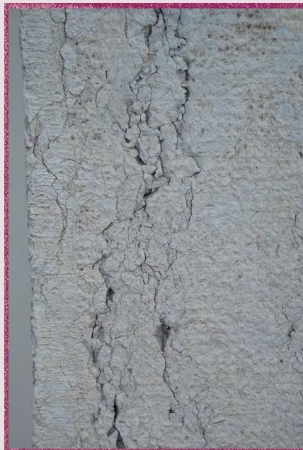
Fig. 14 : Joint stylolithique dans du calcaire graveleux de Chomérac.
