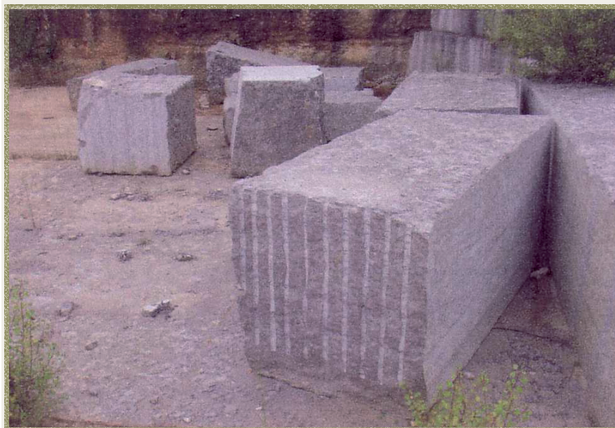
Sur un bloc débité on observe les traces du perforateur.
