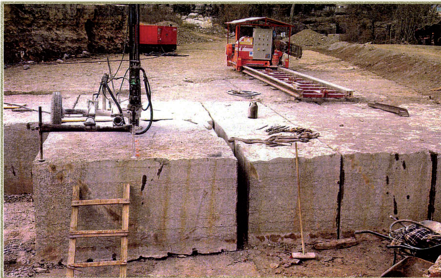
Haveuse Fantini et perforateur en action.
